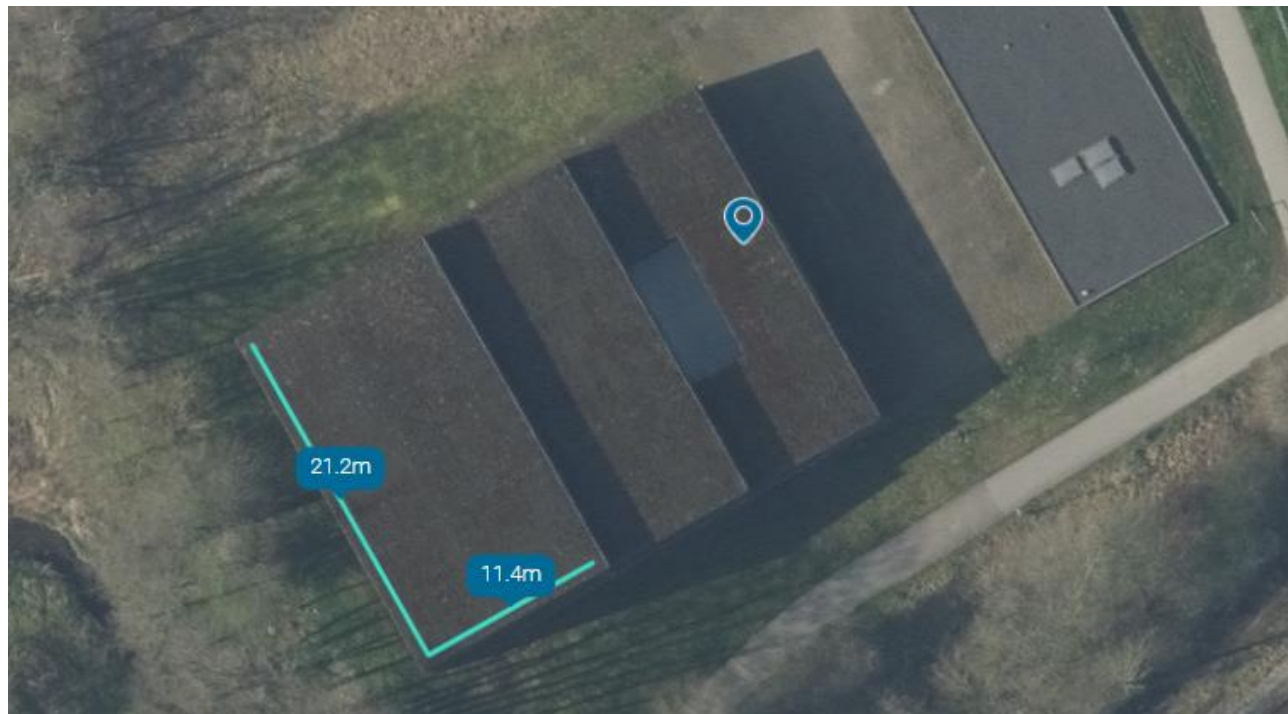
Figur 7.2: Foreslået placering af solceller på Gråsten Vandværk.
