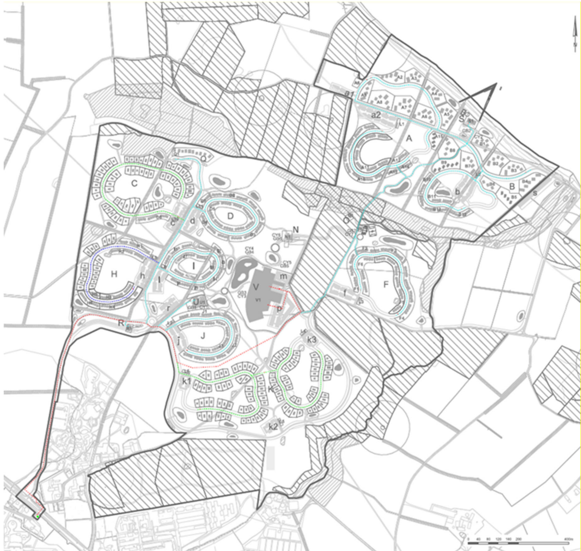
Figur 3: Nordals Feriecenter projektområde (udsnit kort 10 4) – med tilhørende fjernvarme ledningsnet startende med rød fordelingsledning fra Majløkke pumpebygværk. Fjernvarmeledningerne med stik følger sammen med de øvrige forsyninger i vej- og stisystemet
